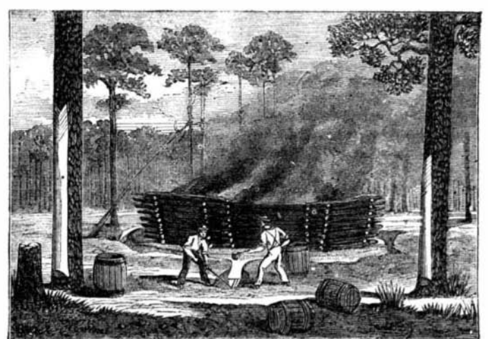
FIG. 6.—BURNING A TAR KILN.
